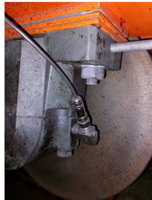
Sensor (comprobador de rodamientos)
