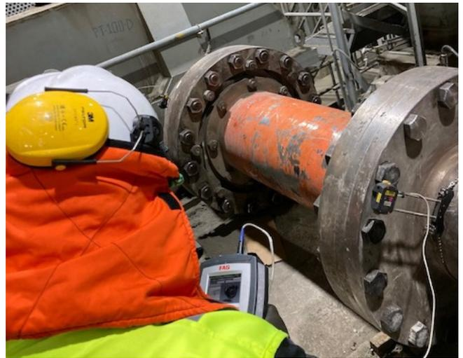
Ausrichten der Welle mit dem Ausrichtsystem LASER-EQUILIGN im alten Design. Nachfolger ist der LASER-EQUILIGN2 mit verbessertem Design, mehr Funktionen und noch präziserer Technologie.
