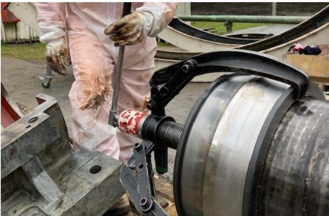
Hydraulischer Abzieher für die Demontage des Lagers
