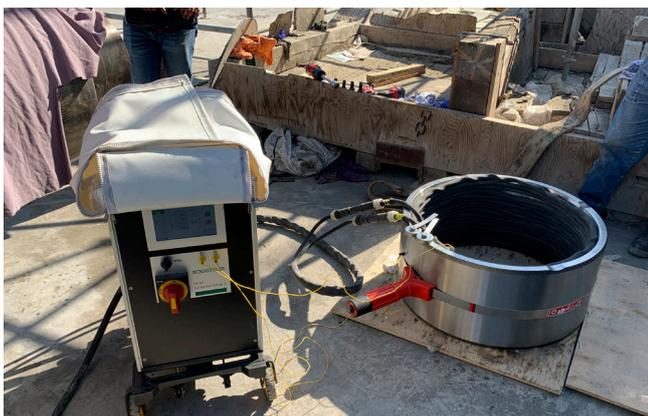
Schaeffler Induktionsanlage mit Mittelfrequenztechnologie im alten Design und Bauform.
