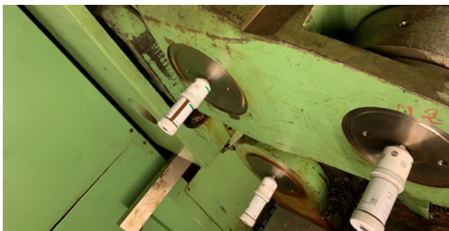
Graisseur sur les paliers lisses de la presse à étages
