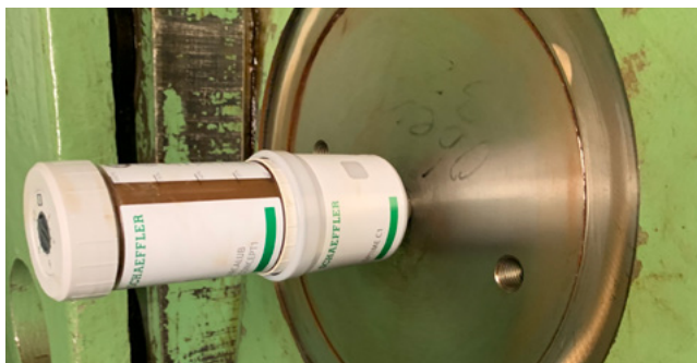
Vue rapprochée : graisseur sur les paliers lisses de la presse à étages
