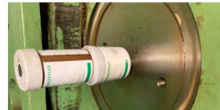
Primer plano: lubricador en los casquillos de fricción de la prensa multietapas
