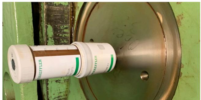
Nahansicht: Schmierstoffgeber an Gleitlagern der Stufenpresse
