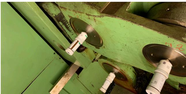
Schmierstoffgeber an Gleitlagern der Stufenpresse
