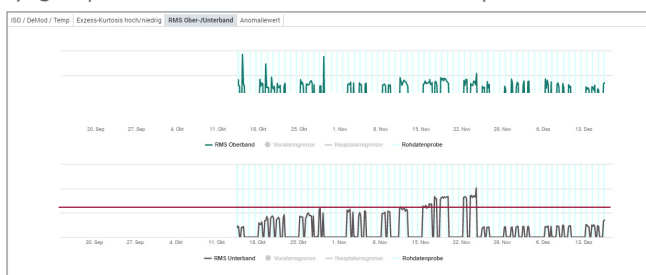
Figure 1 – ventilateur d'air frais du four de refroidissement de produits 1 : la vibration basse fréquence a augmenté, ce qui indiquait un déséquilibre du ventilateur.
