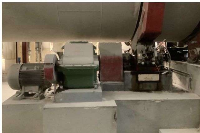
Entraînement du four tournant
