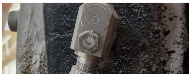
Un des 11 capteurs de vibrations de ProLink CMS (voir page 5)
