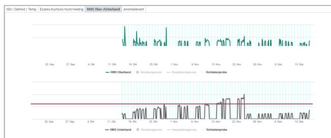
Abbildung 1 – Frischluftgebläse Produktkühleröfen 1: Die niederfrequente Schwingung stieg an, was bei dem Lüfter auf eine Unwucht schließen ließ.
