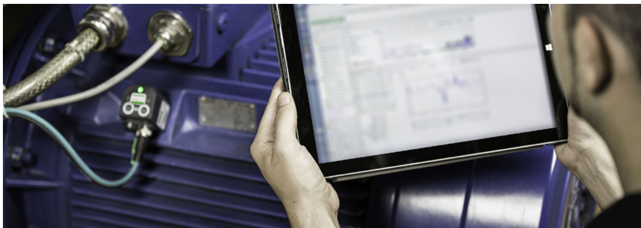
Surveillance permanente des machines avec SmartCheck et son logiciel
