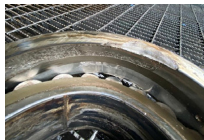
Détérioration des roulements localisée plus tôt sur le palier
