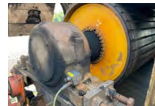
El SmartCheck instalado en el soporte del rodamiento
