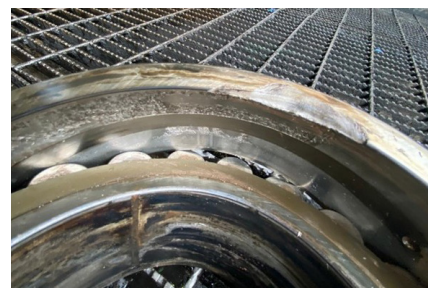
Lagerschaden zuvor am Gehäuse lokalisiert
