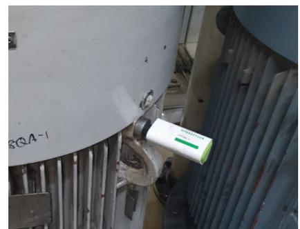
OPTIME auf einem vertikal laufenden E-Motor montiert.
