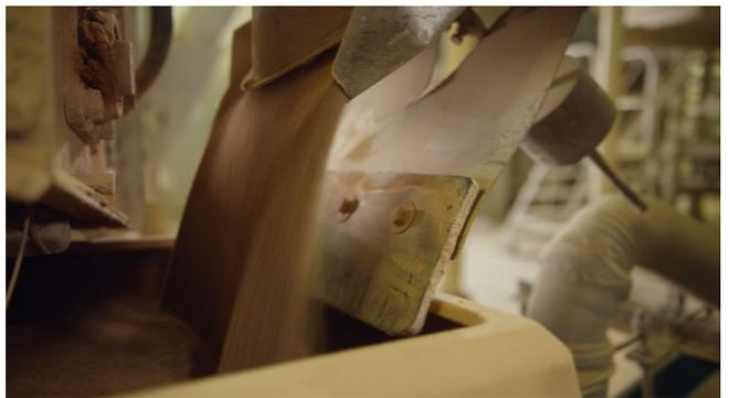
Granulat tritt aus dem Sprühturm aus
