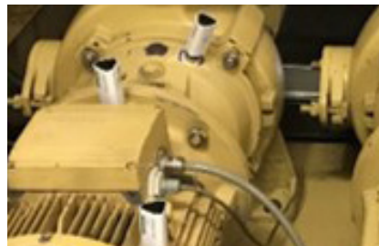
Nahansicht: OPTIME-Sensoren an einem KSB-Motor
