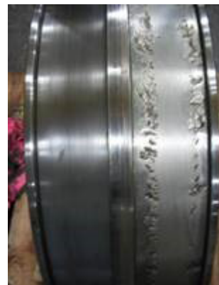
Daños en la superficie de un rodamiento oscilante de rodillos convencional debido a una lubricación parcial y una distribución irregular de la carga
