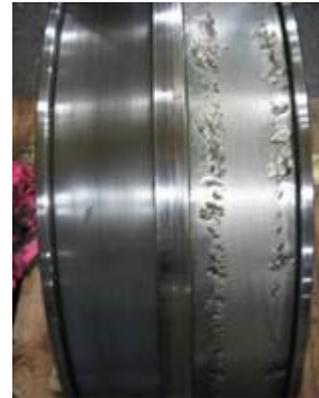
Oberflächenschäden an einem herkömmlichen Pendelrollenlager aufgrund von Teilschmierung und ungleicher Lastverteilung
