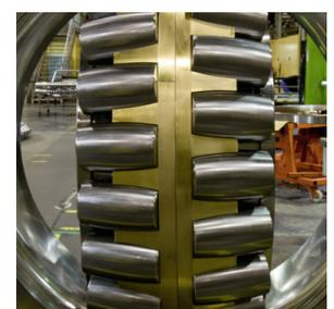
Einbaufertig: riesige Pendelrollenlager mit Messingkäfig, einem Außendurchmesser von 1.420 mm und einem Gewicht über drei Tonnen.
