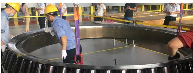
Montaje del anillo interior del rodamiento de rodillos cónicos
