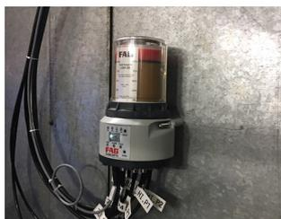
CONCEPT8 assure une lubrification précise des roulements.
