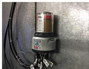
CONCEPT8 asegura la lubricación precisa de los rodamientos.
