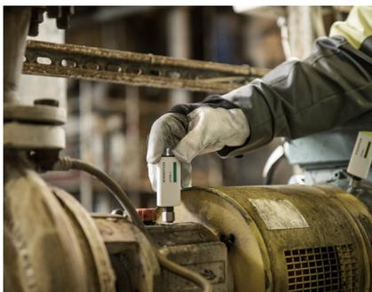
Schaeffler OPTIME wird montiert.
