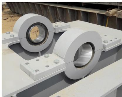
Rótulas de Schaeffler montadas en una de las compuertas de segmento.
