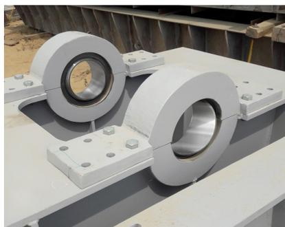
Schaeffler-Gleitlager an einem der Segmentschütze.
