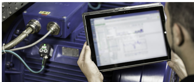
Surveillance permanente des machines avec SmartCheck et ses interfaces
