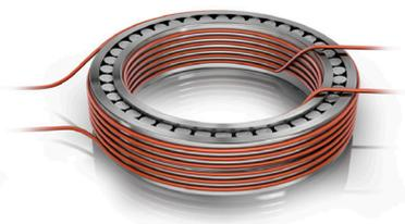
Anwärmen des Außenrings durch Anbringen des Induktors am Außenring. Anschließendes Anwärmen des Innenrings durch Anbringen des Induktors am Innenring.
