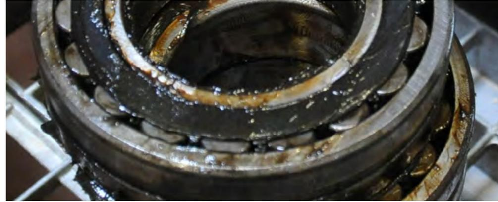
Del engrase excesivo de los rodamientos se deriva una sobrecarga térmica y, por consiguiente, un fallo del rodamiento
