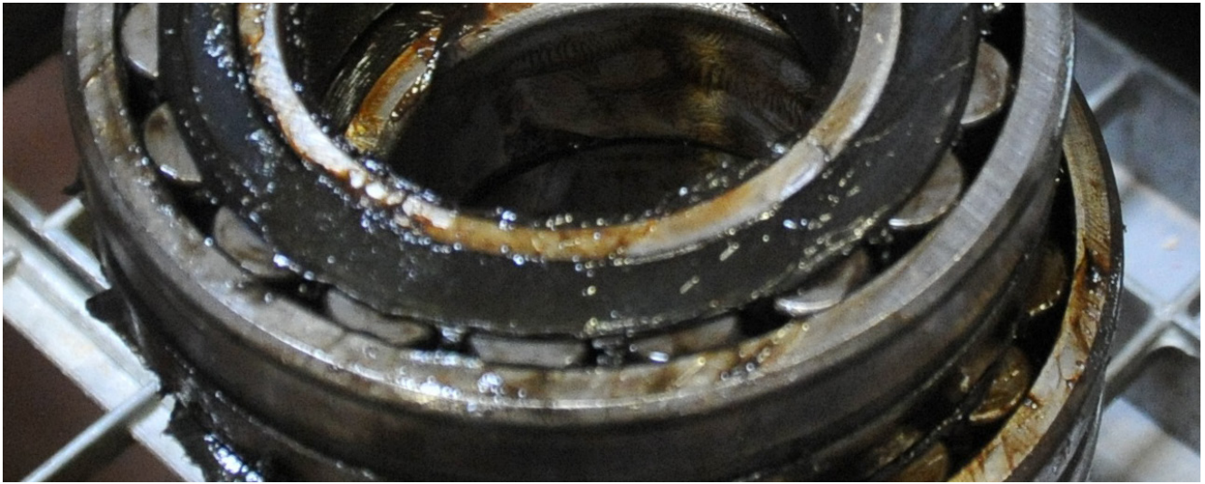
Die Überfettung der Lager führt zu einer thermischen Überlastung und damit zum Lagerausfall
