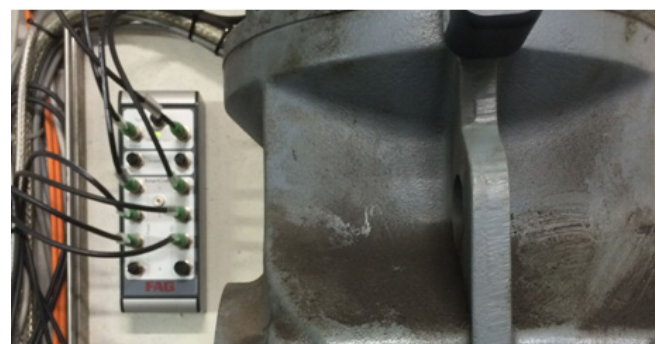
Die SmartConnect Box verteilt Spannung und Zusatzsignale an bis zu vier SmartCheck (hier noch im alten FAG Design)
