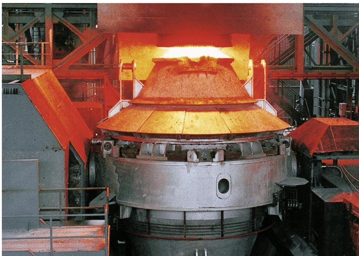
Soporte del convertidor hecho de fundición gris
