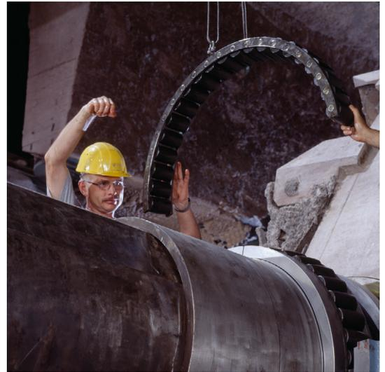
Cambio simplificado del rodamiento gracias al rodamiento partido oscilante de rodillos
