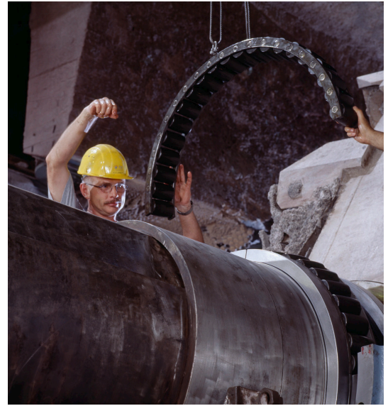
Vereinfachter Lageraustausch dank geteiltem Pendelrollenlager
