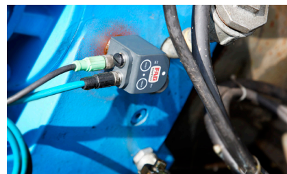
SmartCheck misst Getriebebeschwingungen
