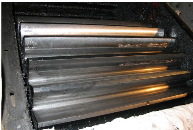
Detektierter Getriebeschaden an der Kugelmühle
