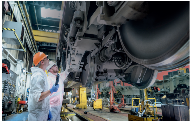
Digitale Instandhaltung: Der DMC auf den Radsatzlagern ermöglicht SBB Schadensmuster mit Betriebsdaten wie Laufleistung, Streckenprofil oder Wagenladung zu korrelieren.
