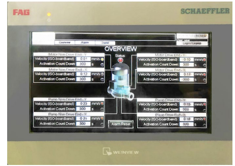
Jedes Aggregat wird mit hoher Detailtiefe separat überwacht und visualisiert
