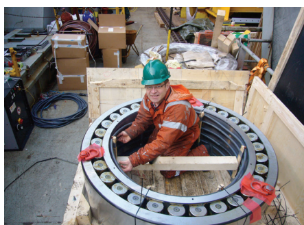
Se envuelve el rodamiento con los inductores flexibles
