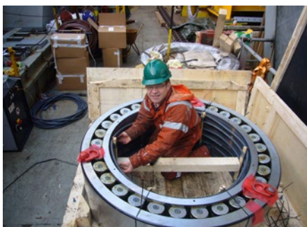
Die flexiblen Induktoren werden ums Lager gewickelt
