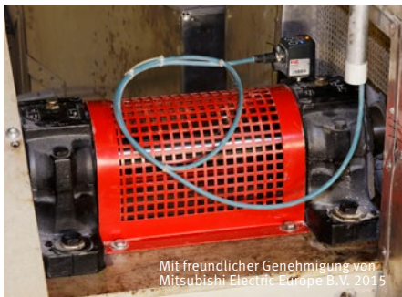
Lüftereinheit: Der FAG SmartCheck sitzt auf der Lagerung der Welle
