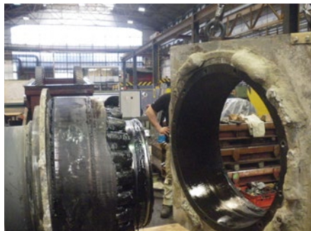
Ausgebautes Pendrollenlager mit Außenring-schaden
