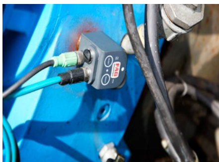
FAG SmartCheck misst Getriebebeschleunigungen
