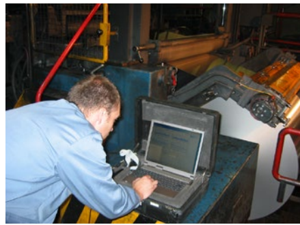
Schaeffler-Schwingungsexperten unterstützen bei der Installation der Messgeräte
