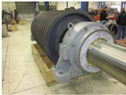
Montage der Antriebstrummel bevor diese zur Mine geliefert wurde
