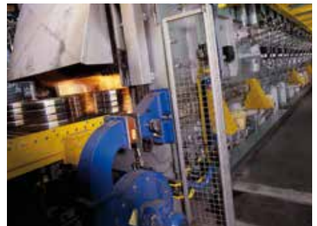
Rollenherdofenanlagen eignen sich zum Härten aller gängigen Wälzlagerstähle
