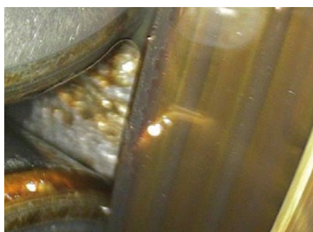
Daños en la pista de rodadura del anillo interior
