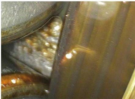
Schaden an der Laufbahn des Innenrings
