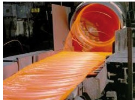
Der noch glühend heiße Draht wird in Form gebracht
