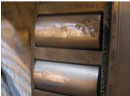
Schaden am Wälzkörper eines Kegelrollenlagers
