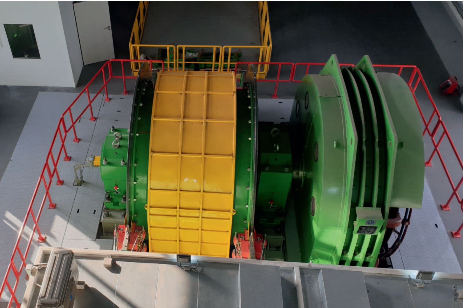
Blick auf das Herzstück der Kupfermine Schacht L-VI in Lubin – die Fördermaschine aus dem Hause MWM Elektro
