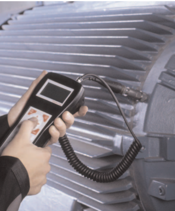
FAG DETECTOR III im Einsatz: Überwachung eines E-Motors bzw. einer Kompressorlagerung
