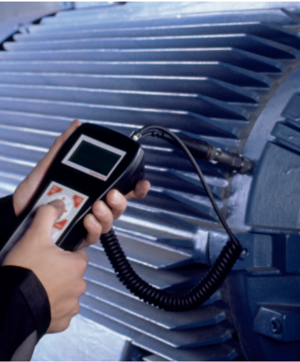
使用中的FAG DETECTOR III 监测电机和压缩机轴承
