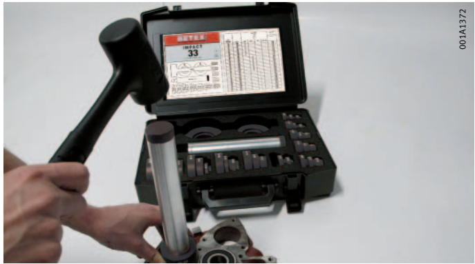
Bild 3 Lagereinbau mit Hammer und Schlagbuchsenset
